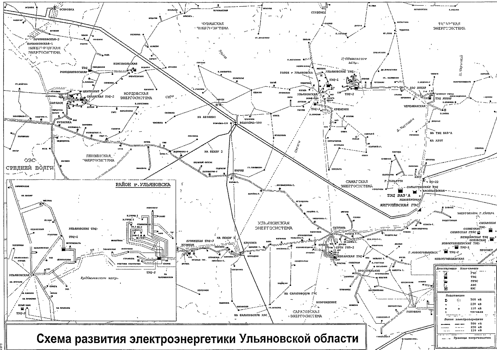
Рис. 2. Карта-схема электрических сетей 110 кВ и выше энергосистемы Ульяновской области на период 2017-2021 годов
